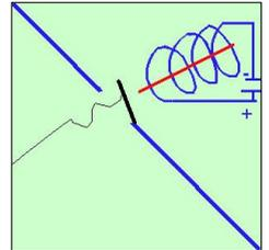
Se poi smetto di erogare corrente al solenoide, allora il campo magnetico sparisce e la molla fa tornare la lamina al suo posto e nel filo puo' ancora passare corrente. Abbiamo quindi un circuito che serve da interruttore per far passare od interrompere il passaggio di corrente in un filo.
