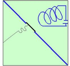
Se ora facciamo passare una corrente elettrica nel solenoide a destra, allora si attiva un campo magnetico che attira la lamina e quindi impedisce il passaggio di corrente nel filo.
